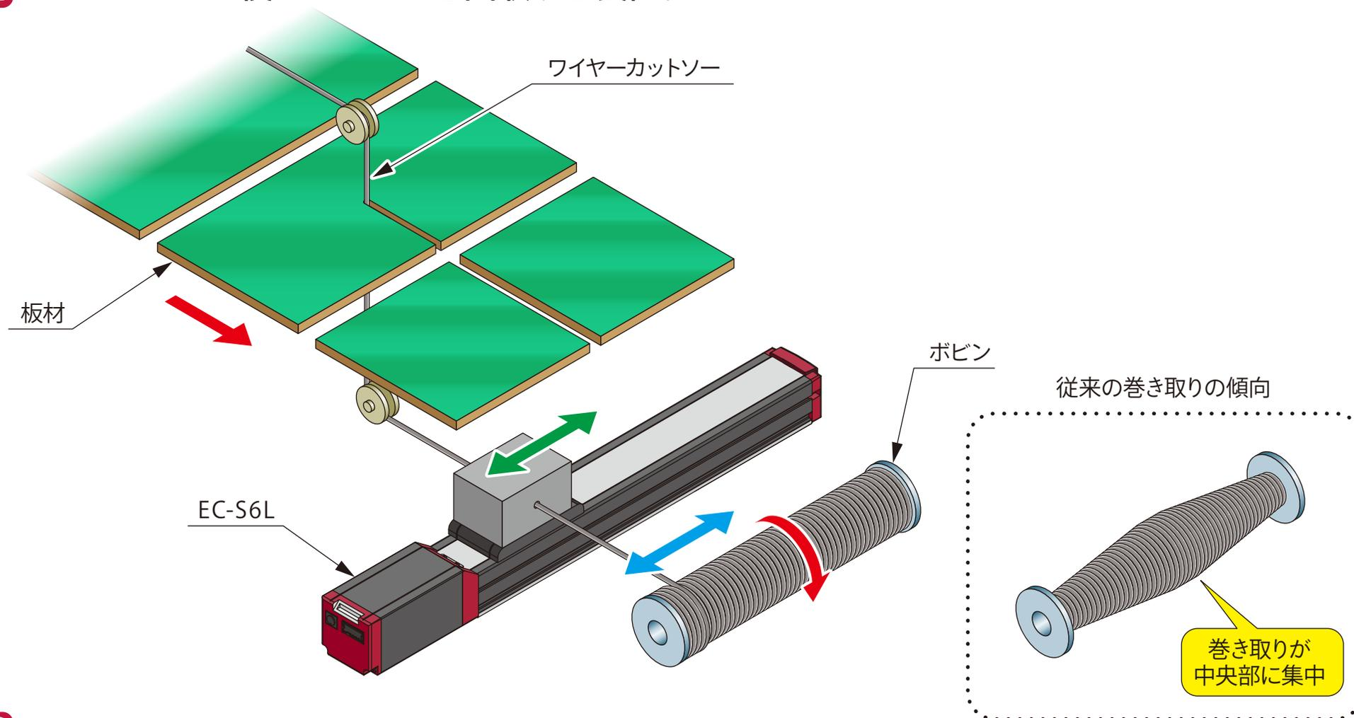
**解説** トラバース機構で整列巻きすることにより、1本のポビンの回収量が増加しました。長尺のワイヤーが使用可能になり、交換時間の削減、生産量アップができました。
