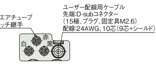
詳細図 X 背面パネル詳細
