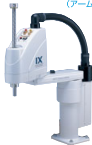
標準タイプより1ランク大きなモータを搭載し、 標準サイクルタイム0.29秒台を実現した 高速仕様です。
