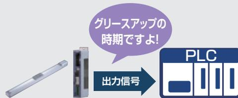
設定した保守点検時期 (動作回数、走行距離) に達すると自動的にPLCに出力します。
