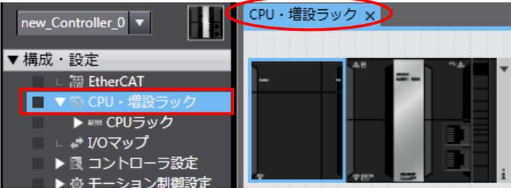
9 [CPU・増設ラック] タブ内で、マウスの右ボタンをクリックし、メニューから、[実ユニット構成と比較・マージ] を選択します。
