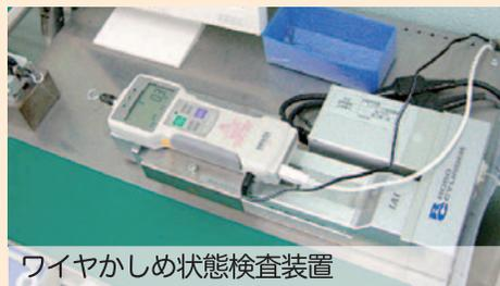
ワイヤかしめ状態検査装置
