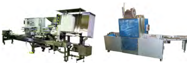
自動充填ラインから流れてきた容器をコンテナに納め、積上げる機械です
