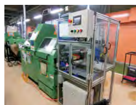
加工機から出てきた製品をロボットでパレットに整列収納する機械です
