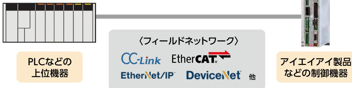
制御機器の間で行う通信手段のひとつとして『フィールドネットワーク』が存在します
