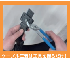
ケーブル圧着は工具を握るだけ!
