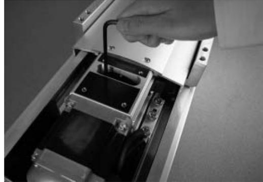
(4) 電源を遮断してから中継コネクタを全て外します。
