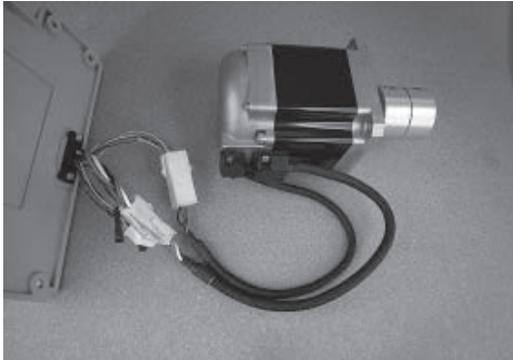
新モータユニットは、以下のようにカップリングを取付けて納入します。
