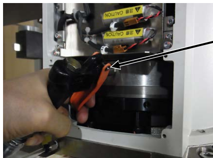
減速機内部加圧
