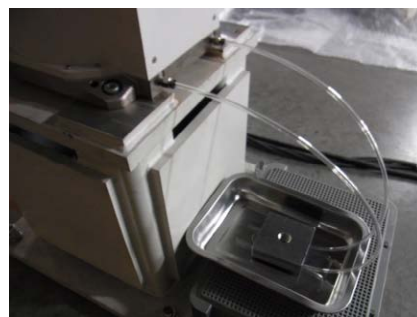
下部給油口配管後
