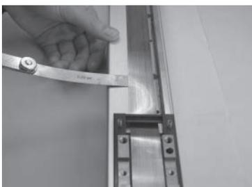
取付ける際に、ステンレスシートの端面と接触しますと損傷や蛇行が生じてシートの早期劣化・消耗の原因になります。このため、シート端面と接触しないように、シートとカバーの間にシム(0.1～0.2mm程度)を差込み軽く浮かせるようにしてカバーを押し込んでください。
