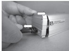
モータエンドキャップを押し込みながらケーブル根元は逆に引き出します。
