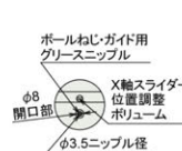
詳細図 V1 X軸スライダー グリース給油口
