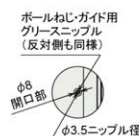
詳細図 V3 Z軸スライダー グリース給油口
