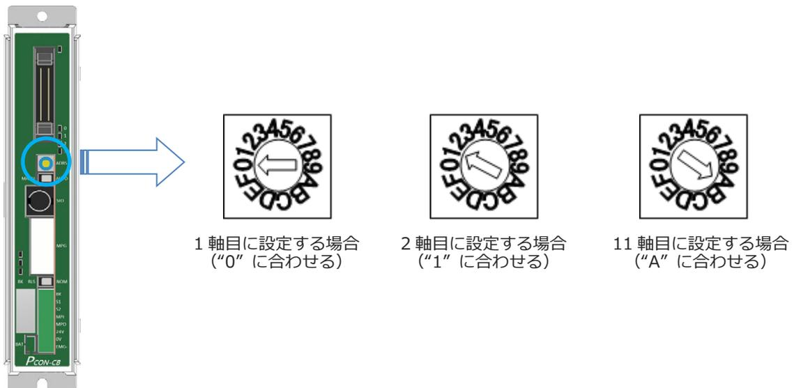
図 3.5-1 ロータリスイッチのあるコントローラの設定
