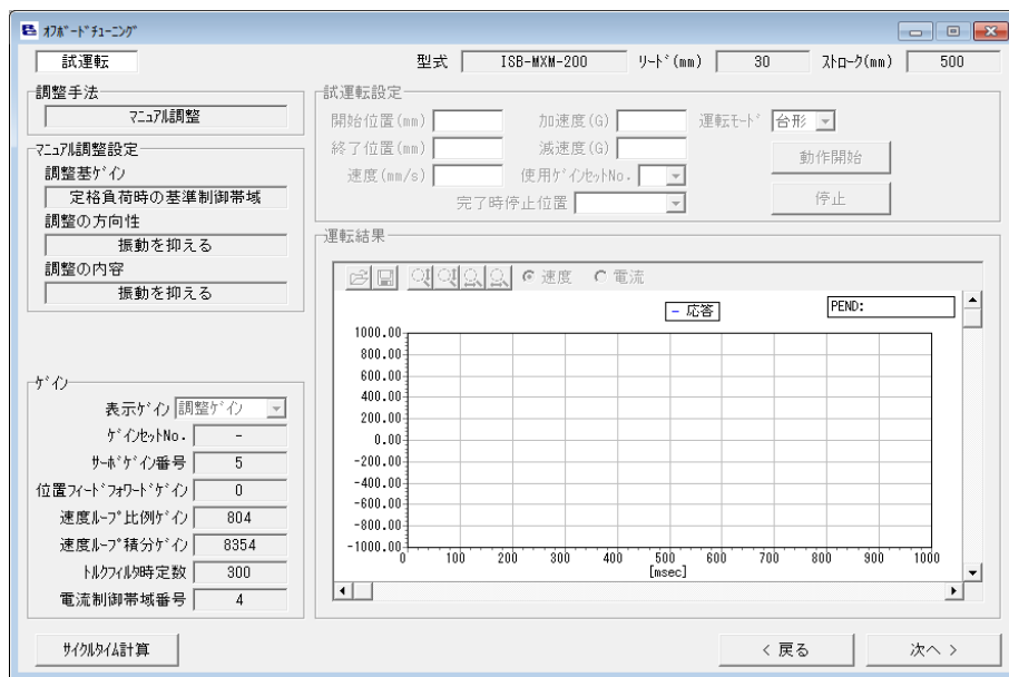
図 14.46 試運転画面(オフライン作業時)
