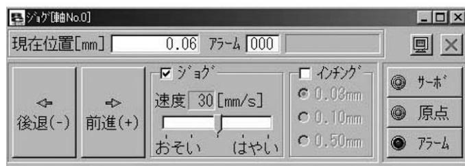
図 5.7 ジョグ画面(オンライン表示)：PCON-PL/P0、ACON-PL/P0、SCON-C、SCON-CA、SCON-CB、PCON-CA、PCON-CB、ACON-CA、ACON-CB、DCON-CA、DCON-CB、ERC3 のパルス列モード
