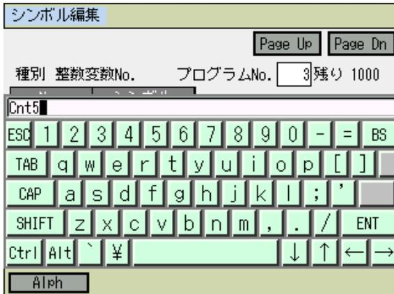
‘C’の入力は **[SHIFT]** をタッチした後、**[C]** にタッチします。自動的に小文字入力となりますので、続けて **[h]** **[5]** を入力し、**[ENT]** にタッチします。
