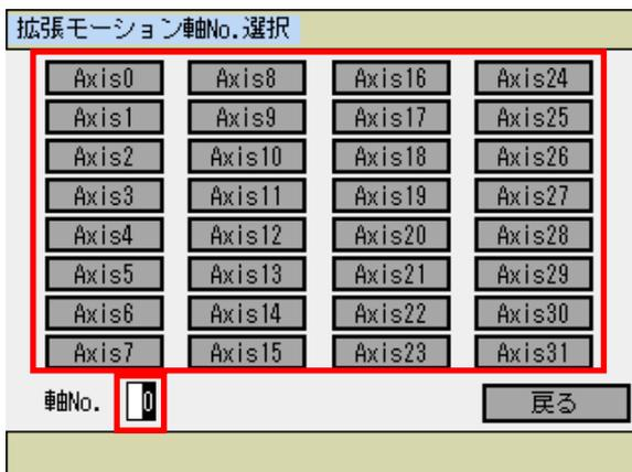
モニタする拡張モーション制御軸 No.を、該当のボタンをタッチして選択してください。また、下の「軸 No.」欄にカーソルがある場合は、ハードウェアテンキーで拡張モーション制御軸 No.を入力して**Enter**キーを押すことでも選択できます。
