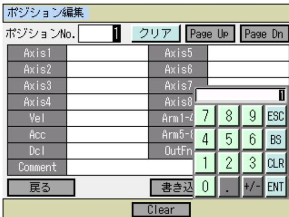
ポジション No.の入力をタッチパネルテンキーで行いたい場合は数字部分をタッチします。入力内容はタッチパネルテンキー上部のBOXに表示されます。
