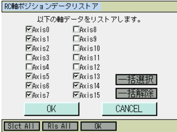
RC 軸用ポジションデータファイルを同時に転送する場合
