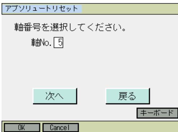
入力が確定するとカーソルが消えます。再入力したい場合には軸 No.入力欄をタッチするか、**ESC** キーを押します。
