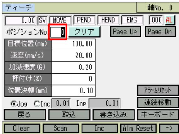
キーボードボタンをタッチし、タッチパネルテンキーを表示させポジション No.を入力するか、ハードウェアテンキーでポジション No.を入力します。
