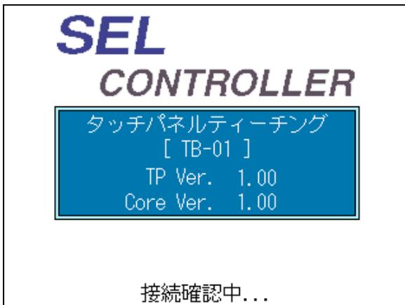
ティーチングボックスのバージョンを表示し、下のメインメニュー画面に移行します。
