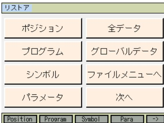
転送したいデータ種別を、該当のボタンをタッチするか **F1**~**F4** キーを押して選択します。**次へ**ボタンをタッチすると、画面に表示されるデータ種別が切り替わります。**SF**(->) キーを押すと、ファンクションキーに表示されるデータ種別が切り替わります。
