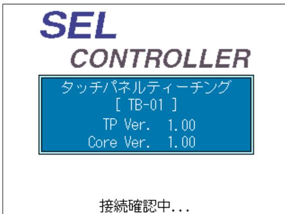
弊社ロゴマークが出たのち、左図の画面が表示されます。再接続中は“接続確認中...”が点滅しています。
