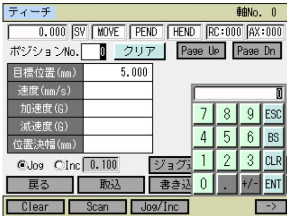
ポジション No.をタッチパネルテンキーで入力したい場合は数字部分をタッチします。入力内容はタッチパネルテンキー上部の BOX に表示されます。入力数字を確定したい場合は **ENT** をタッチします。タッチパネルテンキーが閉じられ、指定したポジション No.のデータが表示されます。入力をやり直したい場合には **ESC** をタッチします。入力自体も取りやめたい場合は再度 **ESC** をタッチし、タッチパネルテンキーを閉じます。なお、ハードウェア **ESC** キーでも同様の働きをします。
