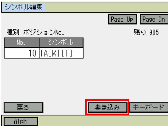
**書き込み**ボタンにタッチするか、**WRT**キーを押してシンボルデータをコントローラに転送します。コントローラへの転送完了後、元のプログラム編集画面に戻ります。
