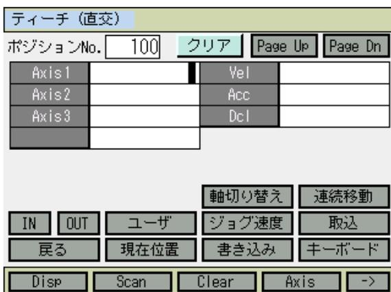
ポジション No.入力欄にタッチしカーソルを表示させハードウェアテンキーまたはタッチパネルテンキーで入力します。(タッチパネルテンキーは**キーボード**ボタンタッチで表示)
