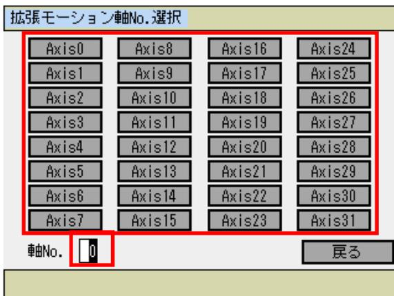
ポジション編集を行う拡張モーション制御軸 No. を、該当のボタンをタッチして選択してください。
