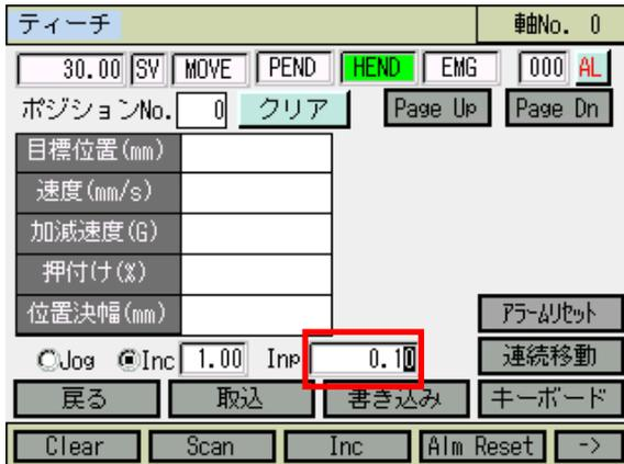
位置決め幅を設定します。(インテグ移動量からどれだけ手前で位置決め完了とするか設定)
