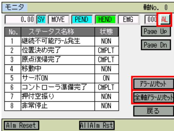
表示中の RC 軸のアラームリセットを行う場合は **AL** ボタンをタッチします。
