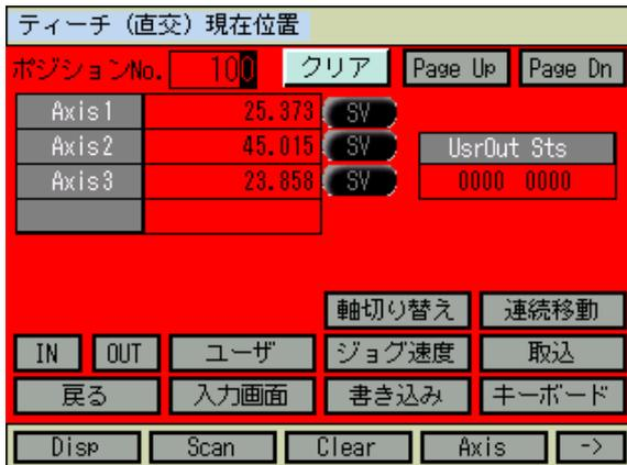
ティーチング画面の状態、**SERVO**キーを押した後、**ALL**キーを押し、サーボ OFF 状態にします。
