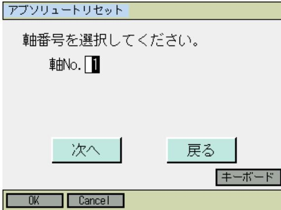
マスタ軸の軸 No.をタッチパネルテンキーやハードウェアテンキーを使って入力し **[ENT]** ボタンやリターンキーで確定させます。
