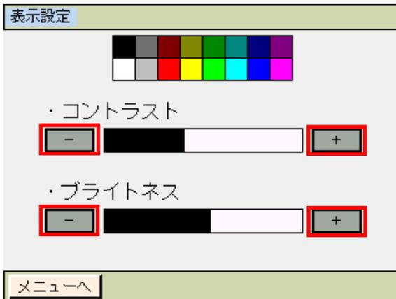
コントラストの $\square$ 、 $\square$ ボタンをタッチして画面のコントラストを調整します。
