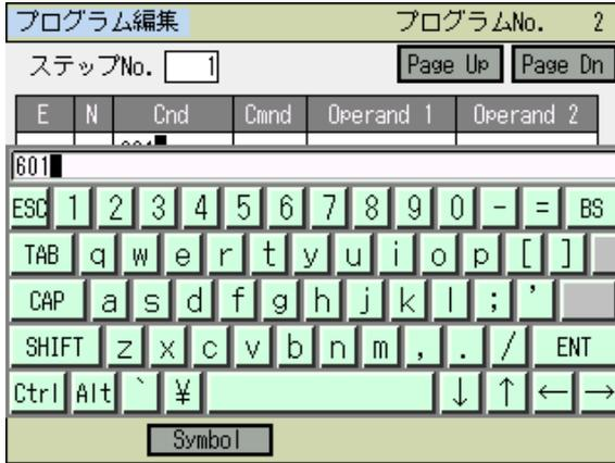
タッチパネルキーボードを使用する場合も 601 と入力し **ENT** をタッチします。タッチパネルキーボードが閉じられ、Cnd に 601 が入力された状態になります。
