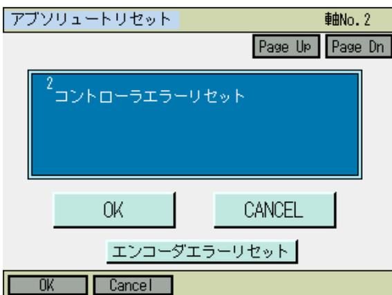
**OK**ボタンにタッチせず**CANCEL**ボタンにタッチするか**ESC**キーを押します。一旦アブソリュートリセットモードを出ます。
