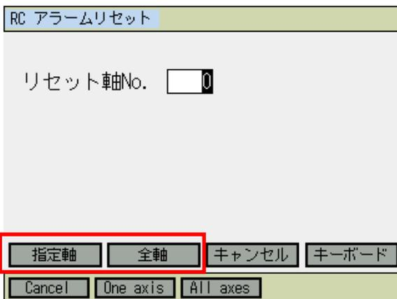
指定軸のみアラームリセットする場合は、**指定軸** ボタンをタッチするか、**F2** (One axis) キーを押します。
