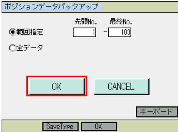
バックアップするポジション No.範囲を入力して、**OK** ボタンをタッチするか **F3**(OK) キーを押します。
