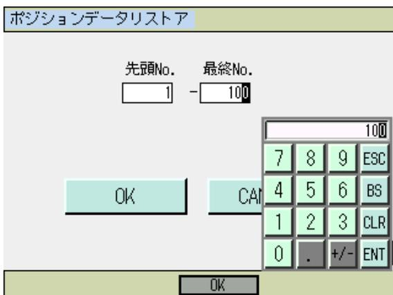
「先頭 No.」「最終 No.」の入力部分にタッチすると、タッチした項目にカーソルが表示されます。カーソルが表示されている状態で **キーボード** ボタンをタッチして、タッチパネルテンキーを表示させ数値を入力するか、ハードウェアテンキーで数値を入力します。
