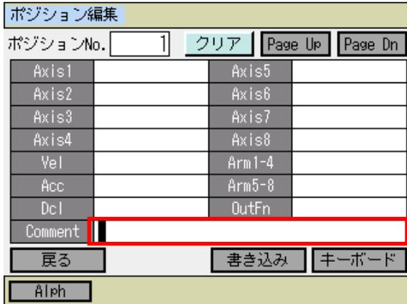
カーソルが表示されている状態で **キーボード** ボタンをタッチしてタッチパネルキーボードを表示させ文字を入力します。
