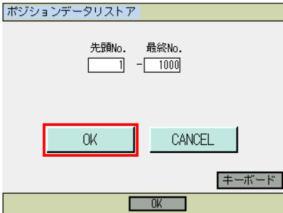
コントローラに転送するポジション No. 範囲を入力して、**OK** ボタンをタッチするか **F3** (OK) キーを押します。
