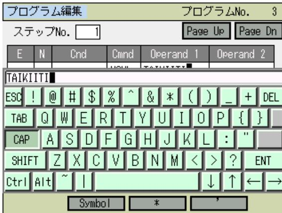
Operand 1 にカーソルがある状態で **キーボード** ボタンにタッチし、タッチパネルキーボードを表示させます。
