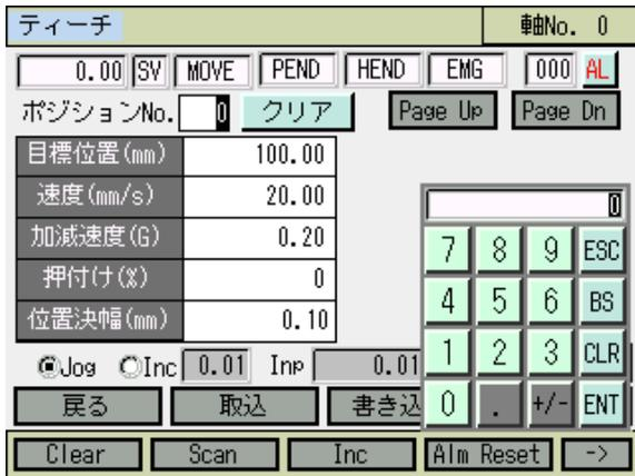
ポジション No.をタッチパネルテンキーで入力したい場合は数字部分をタッチします。入力内容はタッチパネルテンキー上部の BOX に表示されます。
