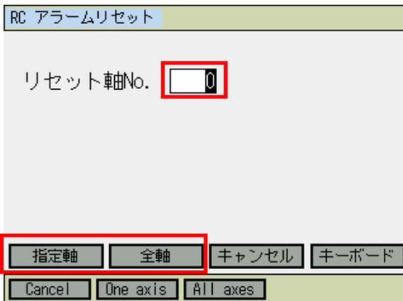
RC モニタ画面で **アラームリセット** ボタンをタッチするか、**F1** (Alm Reset) キーを押した場合は、RC アラームリセット画面が表示されます。
