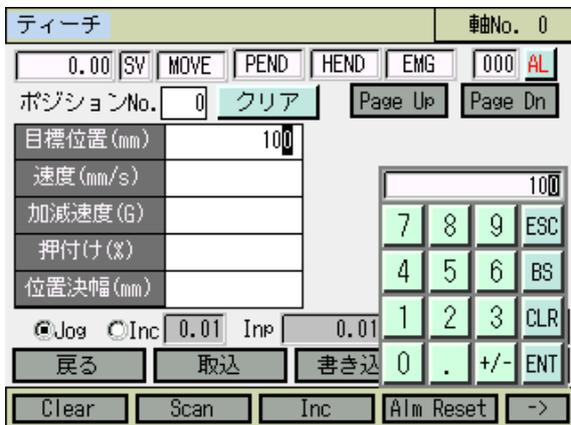
目標位置 (mm) に 100 を入力したい場合、「**キーボード**」ボタンをタッチし、タッチパネルテンキーを表示させ、タッチパネルテンキーで「**100**」とタッチします。
