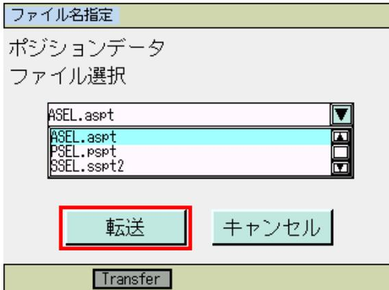
▲、▼をタッチして、SD カードに保存されているファイルの一覧から、コントローラへ転送するファイルを選択します。
