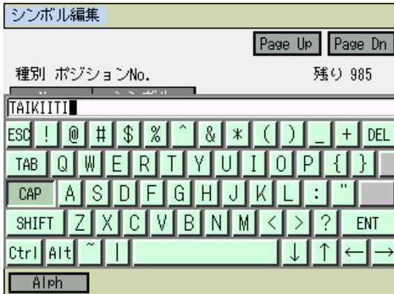
シンボル入力欄にカーソルがある状態で、キーボードボタンをタッチします。タッチパネルキーボードで'TAIKIITI'と入力し、**ENT**ボタンにタッチします。
