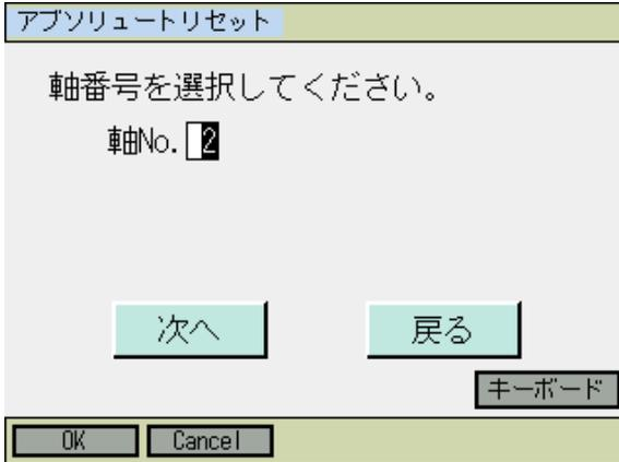
スレーブ軸の軸 No.をタッチパネルテンキーやハードウェアテンキーを使って入力し、**ENT**ボタンやリターンキーで確定させます。**次へ**ボタンにタッチするか**F1**(OK)キーを押します。
