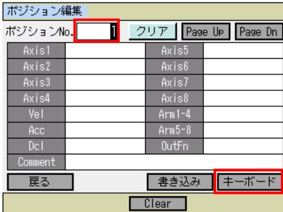
キーボード ボタンをタッチしてタッチパネルテンキーを表示させポジション No.を入力するかハードウェアテンキーでポジション No.を入力します。
