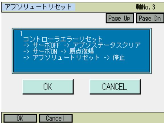
② 原点復帰・アブソリユートリセット **OK** ボタンにタッチするか **F1**(OK) キーを押します。
