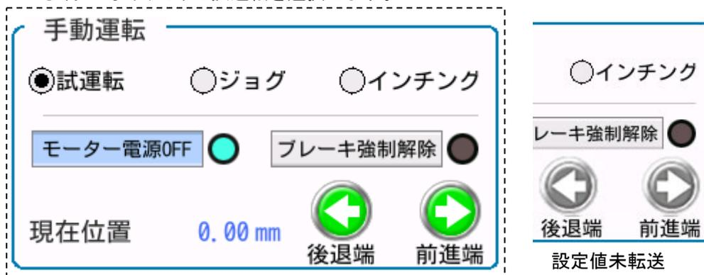
**モーター電源 OFF** をタッチでモーター電源 ON/OFF を切替えます。
