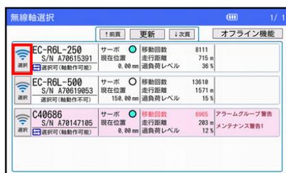
ティーチングボックスで操作を行う軸を表示し、その左側の無線アイコン
