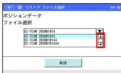
▲、▼をタッチして、バックアップされているファイル名の一覧から、コントローラーへ転送するものを選択します。
