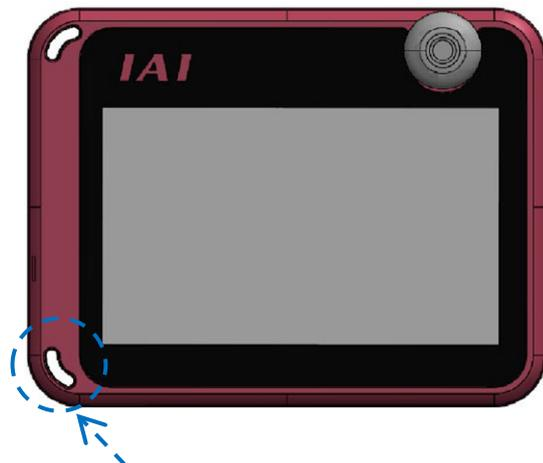
本体左下のスリットに通して、取付けます。
