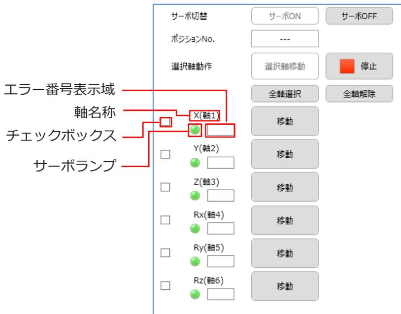
図 7.3- 2 軸制御（スカラロボット/直交型 6 軸ロボット）
