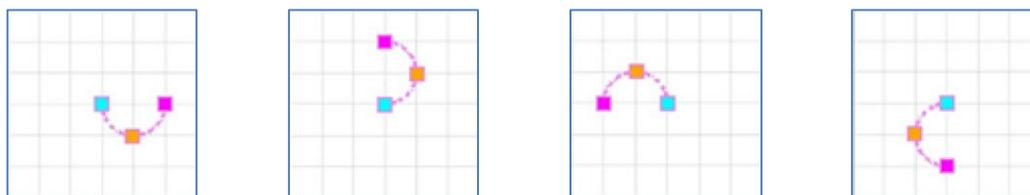
図 9.6- 11 円弧作図 (中心角度を 180°に固定)
