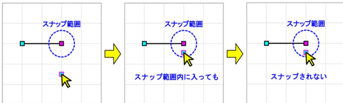
図 9.7- 5 頂点スナップ (スナップ動作を抑止)
