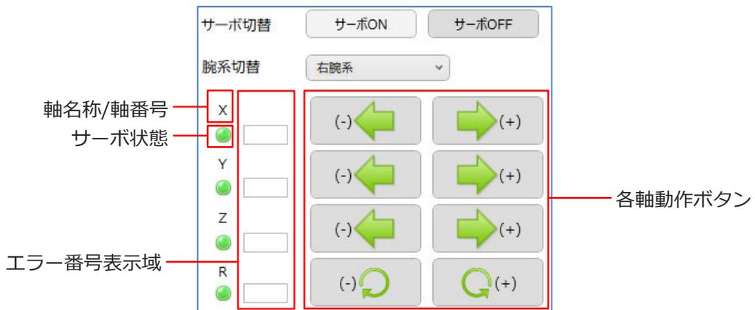
図 7.2- 2 軸制御（スカラロボット/直交型 6 軸ロボット）
