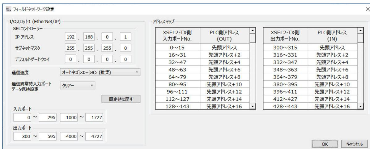
図 5.1- 9 フィールドネットワーク設定 (EtherNet/IP)
