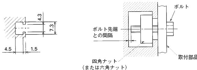
注意：T溝に使用するナットは四角ナットを推奨しますが、一般的の六角ナットでも使用可能です。
