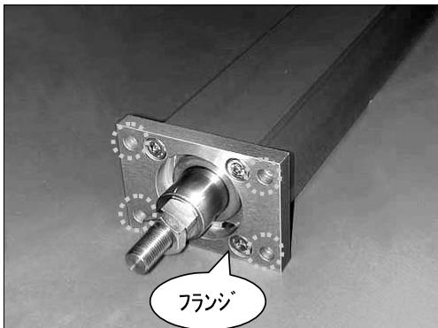
基準面にフランジをボルトで取り付けます。（ガイド付タイプは除く）
