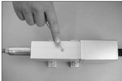
①左図の位置のシンヘッドネジを外します。
