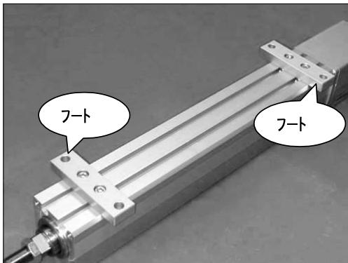
T溝に入れた四角ナットを使用して、フートを取り付けます。
