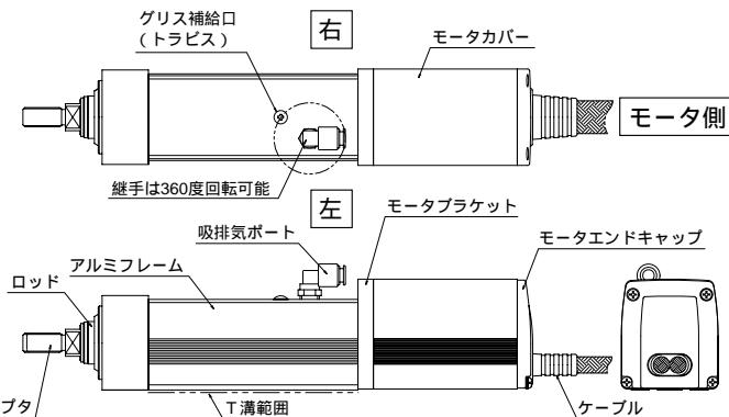
・吸排気ポートにチューブを接続し、反対側の先端は、水分等の影響の無い場所まで引き伸ばして下さい。
