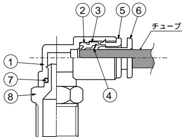
・チューブは左図の②パッキンまで完全に押し込んで下さい。押し込みが不完全ですとチューブの先端が④チャックの部分で止まってしまい、水分等が本体内部まで侵入し、故障します。
