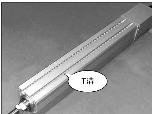
T溝が設けて有ります。このT溝に四角ナットを入れて、架台と取り付けます。
