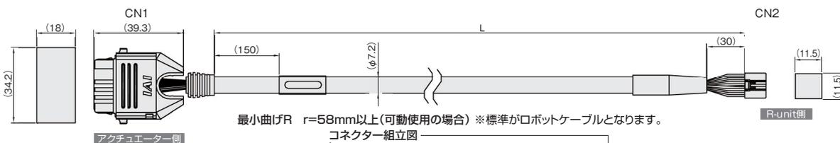
最小曲げR r=58mm以上(可動使用の場合) ※標準がロボットケーブルとなります。
