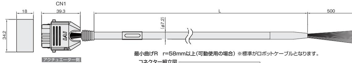
最小曲げR r=58mm以上(可動使用の場合) ※標準がロボットケーブルとなります。
