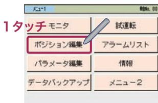
停止位置(目標位置)を入力すると、速度・加速度の項目は、最適な値が自動的に入力されます。
