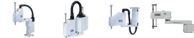
標準タイプより1ランク大きなモータを搭載し、標準サイクルタイム0.29秒台を実現した高速仕様です。
