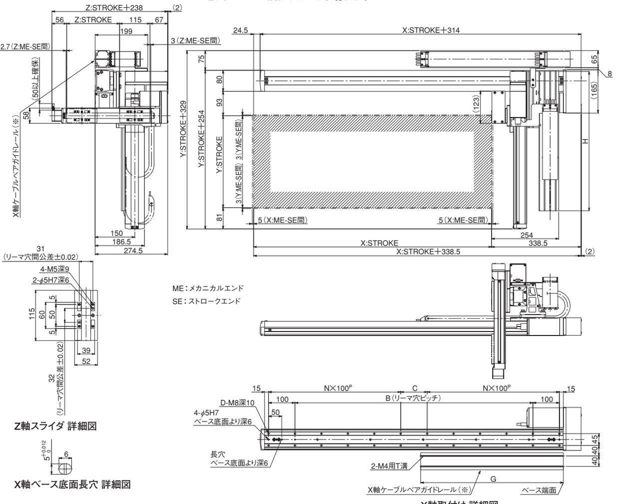
(※) ご注意 X 軸ケーブルベアガイドレールはお客様にて X 軸を設置する面に固定して下さい。
