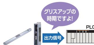
設定した保守点検時期(動作回数、走行距離)に達すると自動的にPLCに出力します。
