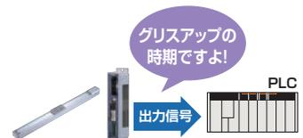
設定した保守点検時期(動作回数、走行距離)に達すると自動的にPLCに出力します。
