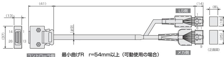
最小曲げR  $r=54\text{mm}$ 以上 (可動使用の場合)
