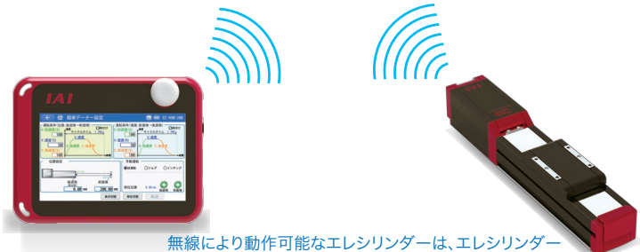
無線により動作可能なエレスリンダーは、エレスリンダー型式オプション欄記載内容によって無線機能が異なります。『-WL』=編集のみ、『-WL2』=編集+動作
