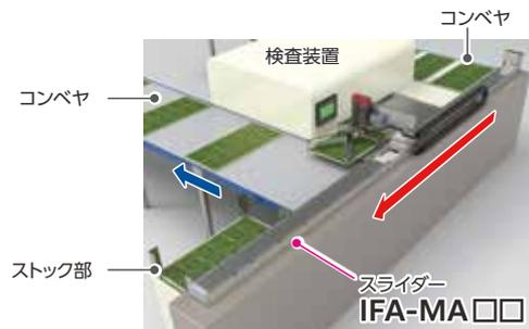
ベルト駆動タイプはストロークによる速度低下がないため、長距離工程間搬送に最適です。ストローク3200mm、最高速度3000mm/sまで対応できます。
