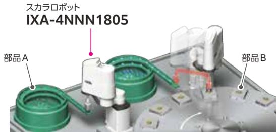
業界最速のIXAは、押付け動作にも対応しています。部品Aを部品Bにはめ合わせる際、位置誤差の補正をかけることができます（コンプライアンス制御）。
