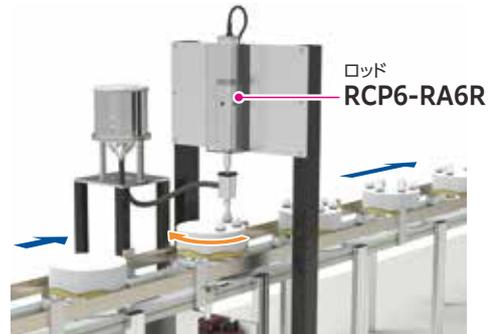
移動中の速度変更が可能のため、クリームの出だしは低速、絞りを高速にすることができます。多点位置決めにより、さまざまな形のケーキに対応できます。
