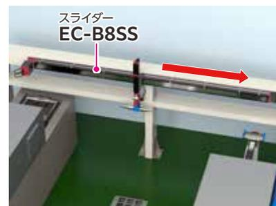
ベルト駆動タイプはストロークによる速度低下がないため、長距離工程間搬送に最適です。バッテリーレスアブソリュートエンコーダーにより、電源投入時の原点復帰も不要です。
