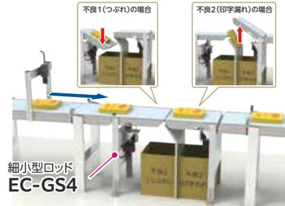
コントローラーを内蔵しつつ全長を短縮した細小型タイプです。ティーチングツールTB-03またはリモスピを使用することで、無線ティーチングが可能です。
