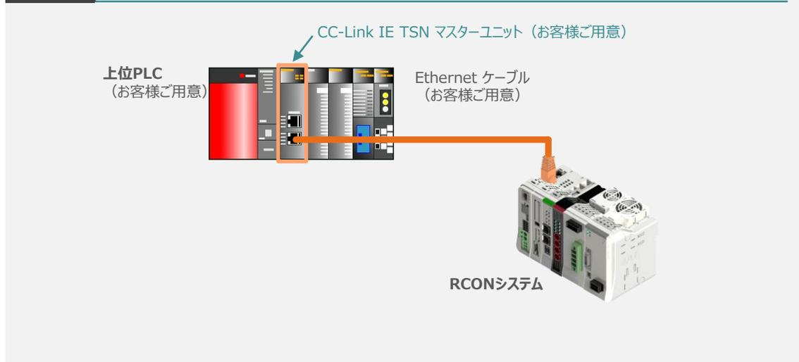
**Point !** Ethernet ケーブルは、1000BASE-T対応（カテゴリ5e以上、二重シールド付・STP）の Ethernet ケーブルを使用してください。
