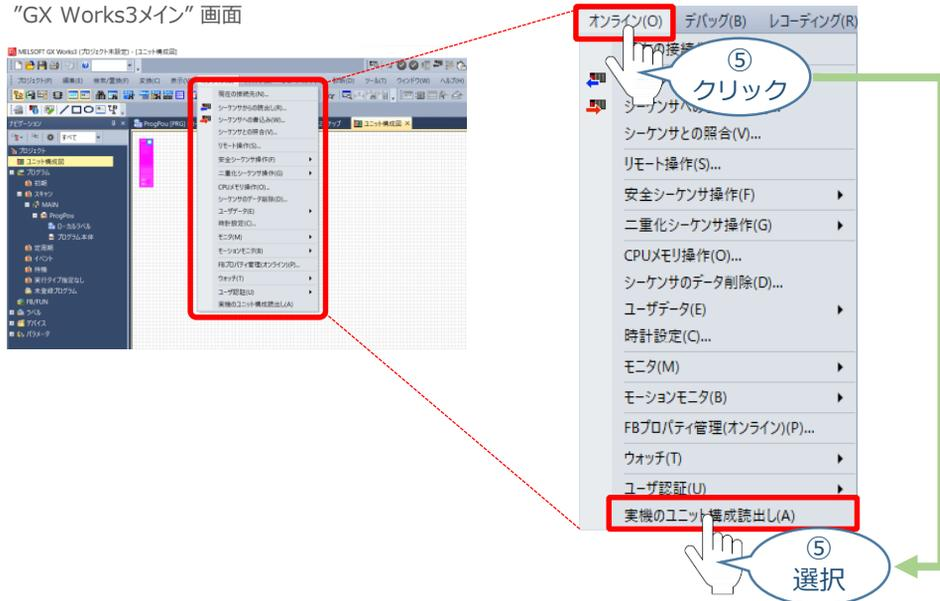
その後、ユニット構成図が表示されます。
