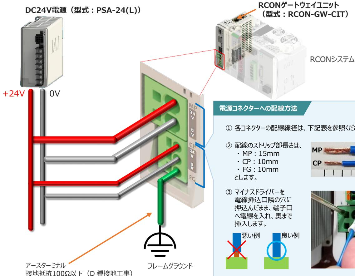
※ 軟銅線：直径1.6mm（2mm<sup>2</sup>：AWG14）以上のアース線で接続してください。
