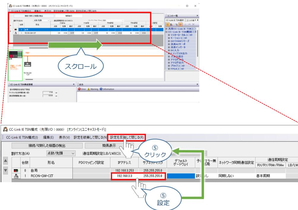
IPアドレスとサブネットマスクを STEP2 **ゲートウェイパラメータの設定 (P44~50)** で RCONのゲートウェイユニットに設定した値と同じ値になるように設定をします。
