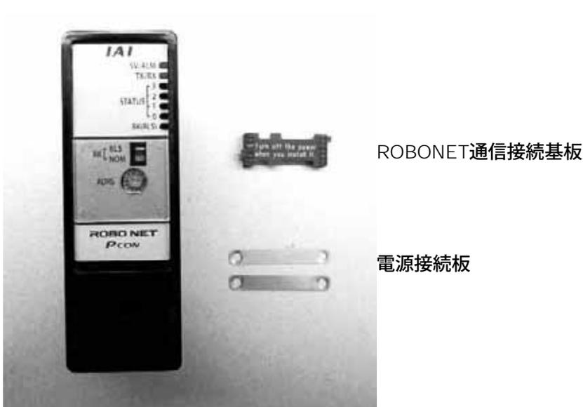
ROBONET通信接続基板
