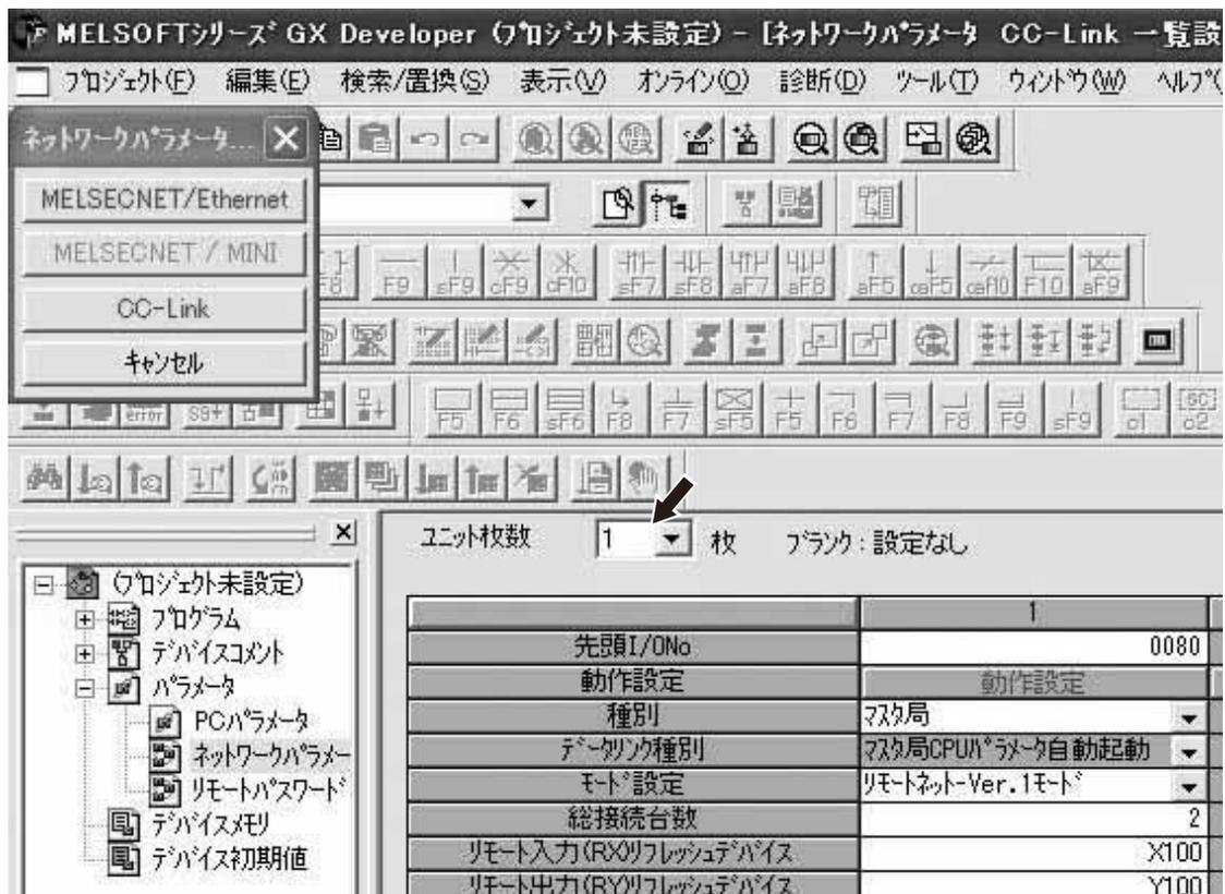
③以下、下図のようにパラメータ設定します。モード設定は、ROBONETゲートウェイパラメータ設定の結果の占有情報 (5.2.2 (3) 軸別動作モードの設定を参照) としてVer.1リモートデバイス局となっていますので、「リモートネットVer.1モード」を設定します。
