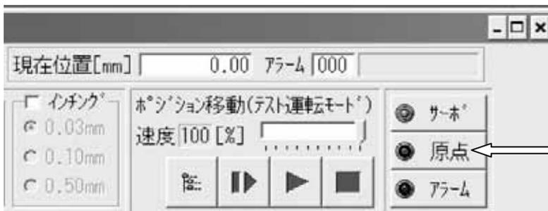
原点復帰が正常に完了すると原点ランプが青色に点灯します。
