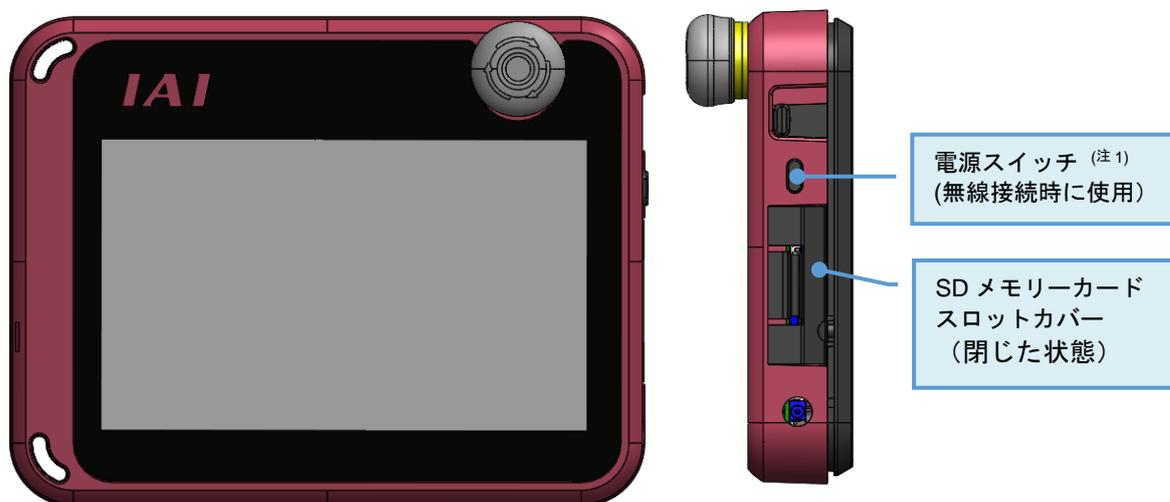
注1 無線接続時、電源を OFF にする場合は、電源スイッチを 2 秒以上長押ししてください。
