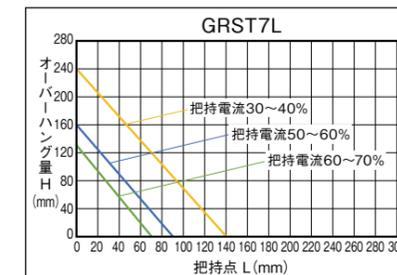
(注) 制限範囲を超えた場合はフィンガー振動部および内部メカに過大なモーメントが作用して、寿命に悪影響を及ぼす原因となります。
