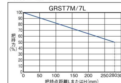
(注) 最大把持力を100%とした時の出し位置による把持力を示しています。使用するフィンガーアタッチメントの剛性により結果が異なる可能性があります。
