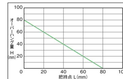
(注) 制限範囲を超えた場合はフィンガー摺動部および内部メカに過大なモーメントが作用して、寿命に影響を及ぼす原因となります。
