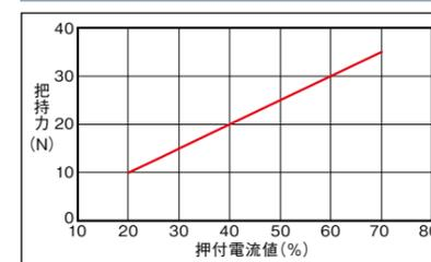
(注) レバー上面での把持力です。実際の把持力は開閉支点からの距離に反比例して低下します。実効把持力は次の計算式より計算してください。
