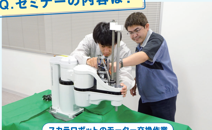
スカラロボットのモーター交換作業
