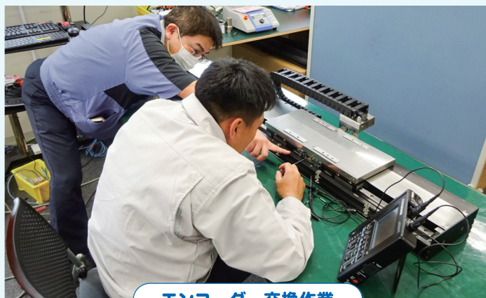
エンコーダー交換作業
