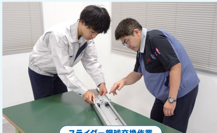
スライダー鋼球交換作業
